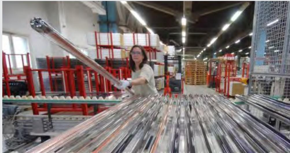
Aufgrund der sehr flachen, nur wenig mit der Temperaturdifferenz abfallenden Wirkungsgradkennlinie des NARVA-Voll-Vakuumrohres sind damit gefertigte Kollektoren neben der Heizungsunterstützung besonders gut für Anwendungen geeignet, die hohe Wassertemperaturen erfordern (Klimatisierungen, Prozesswärme, Trockenprozesse, Wäschereien u.s.w.).
